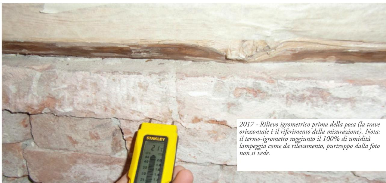
2017 - Rilievo igrometrico prima della posa (la trave orizzontale è il riferimento della misurazione). Nota: il termo-igrometro raggiunto il 100% di umidità lampeggia come da rilevamento, purtroppo dalla foto non si vede.
